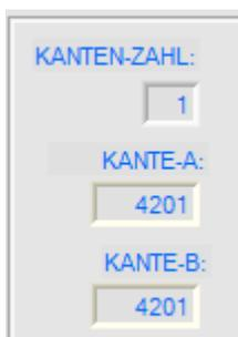
Falls sich die Position des Messobjektes nach unten oder oben verschiebt, wird sich die Position der „Kante“ im VIDEO-Bild nach rechts oder links verschieben. Diese Änderung führt zu einer Messwertänderung, die mittels Toleranzschwellen überwacht werden kann.
