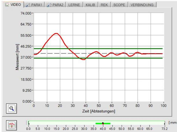
Falls die Register-Karte **[VIDEO]** angewählt ist, wird der aktuelle zeitliche Messwerte-Verlauf oder das Video-Signal des Zeilensensors übertragen.
