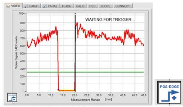
POS-EDGE L/H-TRIGG bei 20.0mm, Objekt: Durchmesser-Bestimmung D
