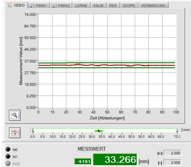
Im Messwerte-Anzeigemodus kann bei langsamer Bewegung des Messobjektes die Messwerte-Änderung (= Position des Messobjektes) beobachtet werden.
