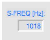
Durch die Mittelwertbildung wird die Schaltfrequenz am *L-LAS-TB-...-AL Sensor* um den Faktor  $1/\text{AVERAGE}$  reduziert.
